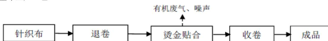
图 2-1 项目生产工艺流程及产污环节图
